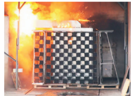
Испытания на локализацию дуги 40кА/1с
